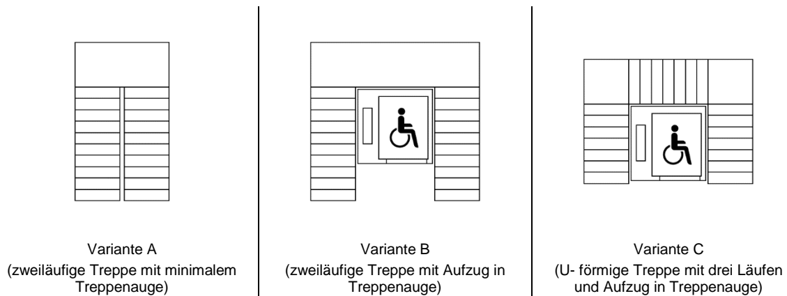
Abbildung 9 – Variantenübersicht der untersuchten Treppenkonfigurationen
