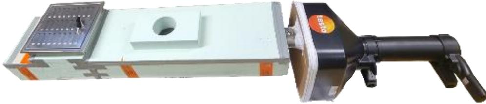
Abbildung 81: Airfox 2 V7. Außenansicht und Messaufbau für Volumenstrommessung.
