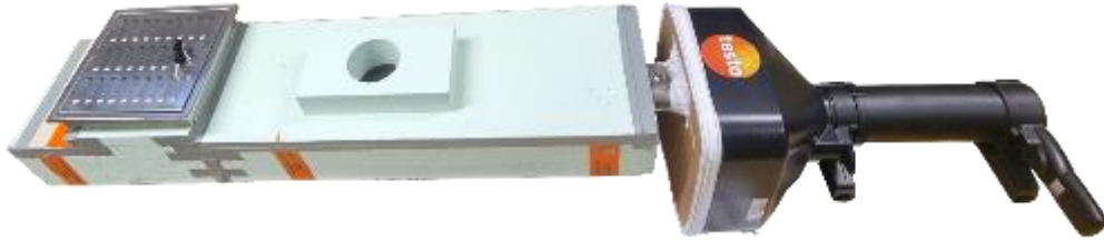
Abbildung 81: Airfox 2 V7. Außenansicht und Messaufbau für Volumenstrommessung.
