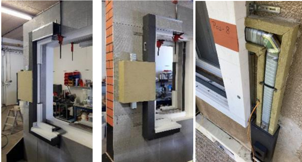
Abbildung 76: Funktionsmuster: Fassadenleitung und Fensterrahmen und finale Version in Adorf (rechts).
